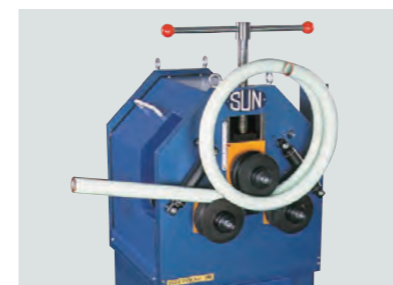
丸パイプ曲げ
